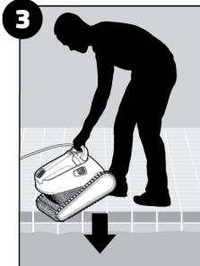
Coloque el limpiador en la piscina. Suelte el limpiador de piscina y deje que se sumerja en el fondo de la piscina. Asegúrese de que el cable flotante no está obstruido.
